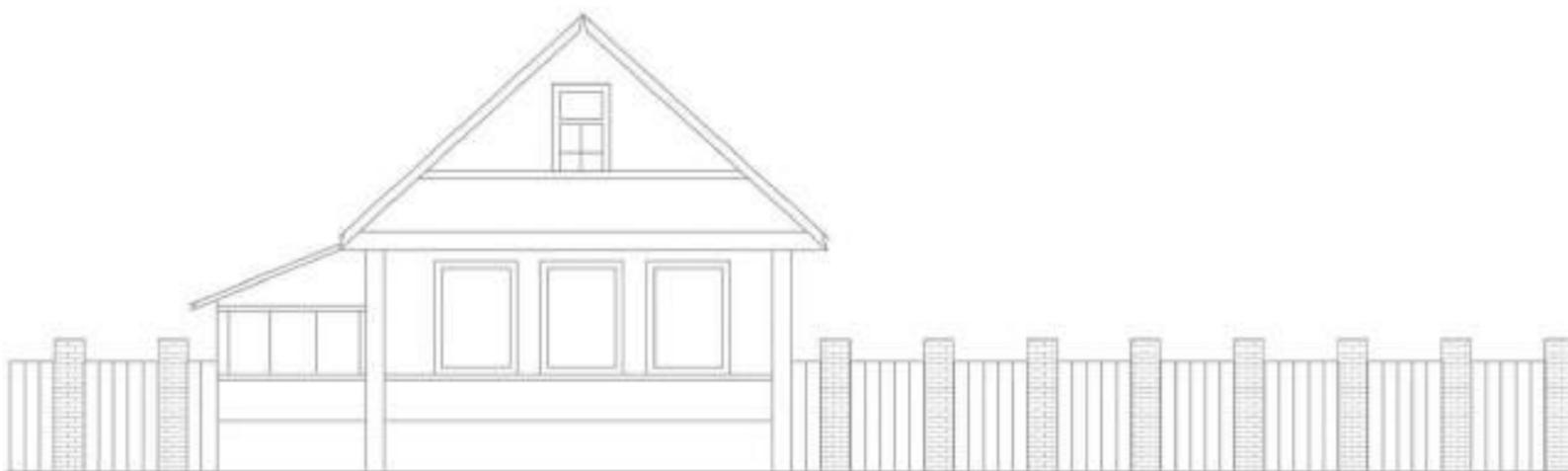
**Допустимо:** Для ограждений с капитальными столбами-опорами в качестве заполнения следует использовать деревянные вертикальные стойки
